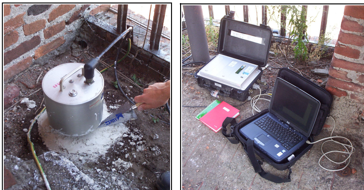
Figura 7.6 - Stazione TS3. Il sensore Mark (a sinistra) è vincolato alla base tramite gesso; a destra un particolare della fase di controllo della strumentazione.
