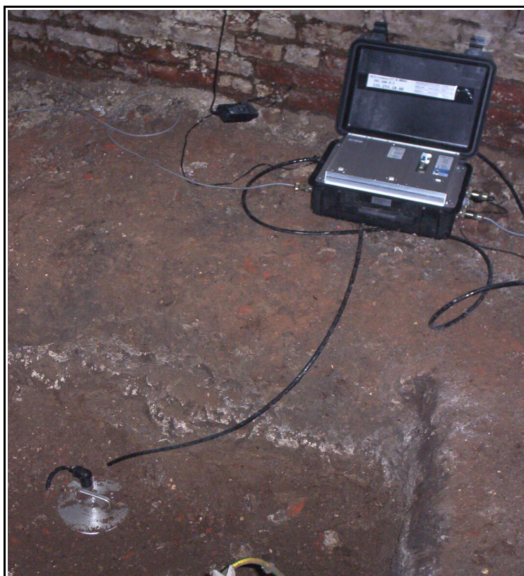
Figura 7.4 - Stazione basale TS0. Il sensore Mark è stato annegato nel terreno di fondazione per facilitarne l'accoppiamento dinamico.
