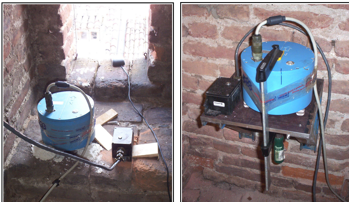
Figura 7.5 - Stazioni TS1 (sinistra) e TS2 (destra). Accanto ai sensori Lennartz (in blu) delle due stazioni sono visibili gli accelerometri dell'Università di Pavia.
